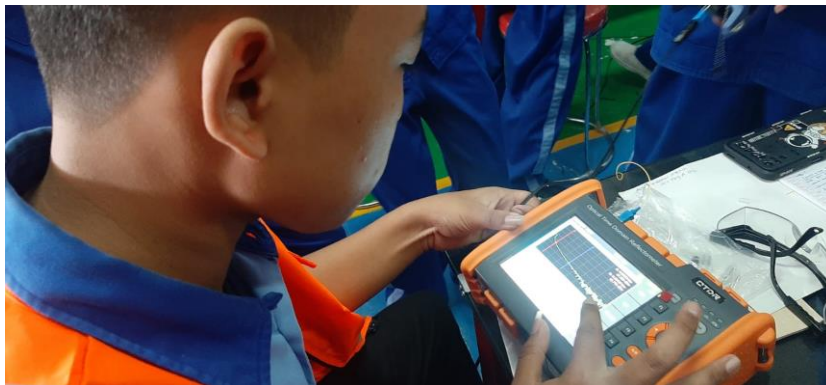
Gambar 4. Siswa melakukan pengukuran kabel fiber optik dan menganalisa hasil pengukuran fiber optik dengan OTDR
